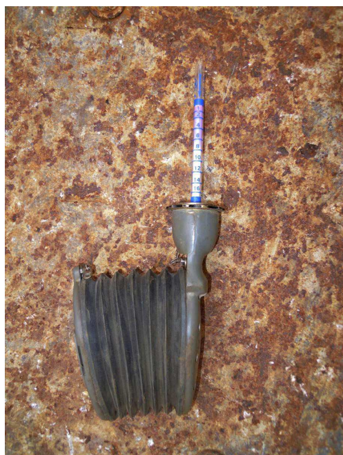
2h/ Zbarvená detekční trubička po měření prosávacem Universal 66 indikuje zvýšenou koncentraci oxidu uhličitého v měřeném vzduchu.
